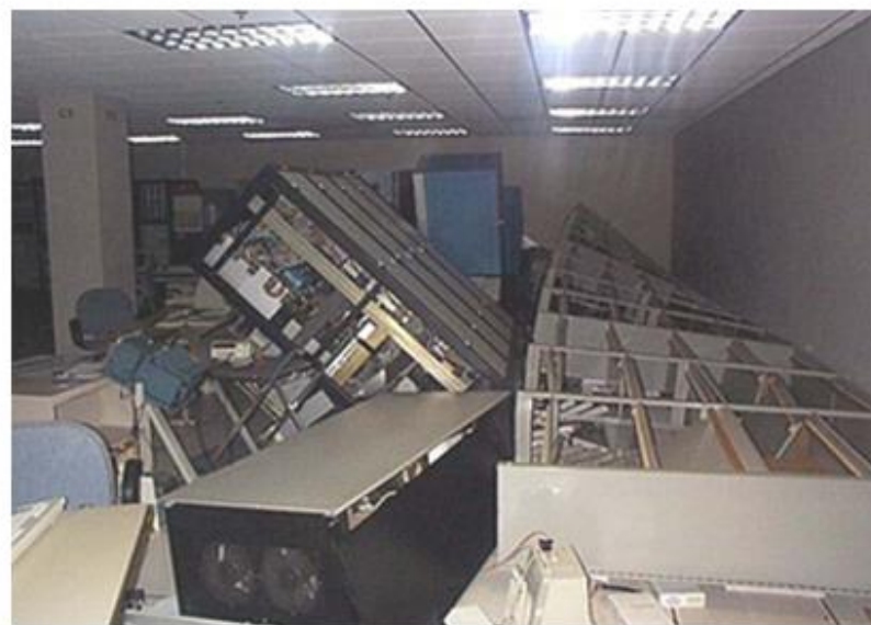
Fig. 9. Daño a equipo de cómputo, eléctrico y comunicaciones, anclaje inadecuado o colapso pisos falsos (FEMA 74, 2012)
