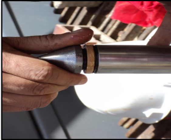
INSTALACIÓN DEL PIEZOCONO CON GEÓFONO TRIAXIAL
