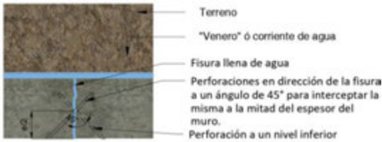
Figura 4. Vista en corte Superior – Perforaciones a 45° atravesando únicamente la fisura
